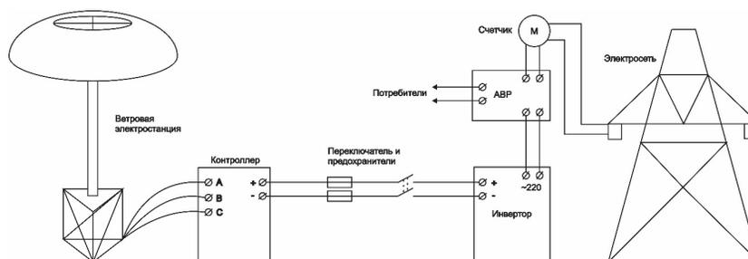
Рисунок 4.14 – Схема дополнительного источника питания
