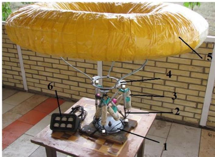
Рисунок 1.18 – Демонстрационная модель ПВЭС с тороидальным парусом [47]
