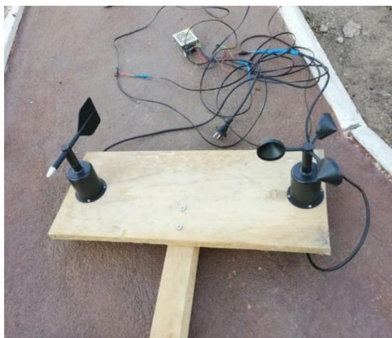
Рисунок 2.2 – Блок питания 220/12В, питающий измерительные приборы через защищенные провода
