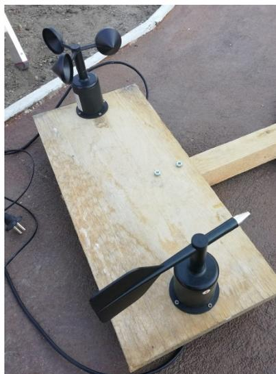
Рисунок 2.1 – Датчики метеостанции
