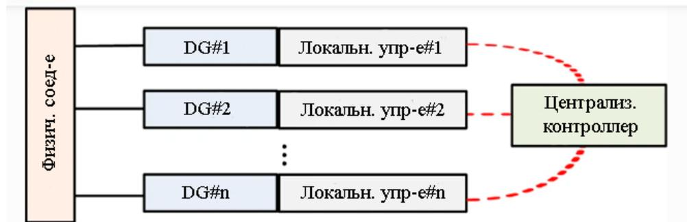
Рисунок 4.27 – Централизованный метод вторичного управления
